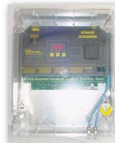
Misuratore differenziale di pressione con generatore
